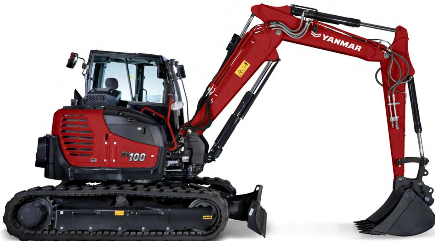
Progettato per massimizzare affidabilità e durata, l'escavatore SV100-2PB adotta numerose caratteristiche per consentire agli operatori di essere produttivi anche nelle attività più impegnative. Ad esempio, la struttura del carro (e l'uso di pannelli di copertura in acciaio) garantisce la totale protezione del telaio. Inoltre, i flessibili sono protetti da guaine resistenti all'abrasione, mentre la loro posizione nella parte alta del braccio previene il rischio di torsione.
